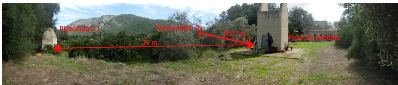
Figura 2. Vista del pozo de bombeo y los piezómetros de control.
